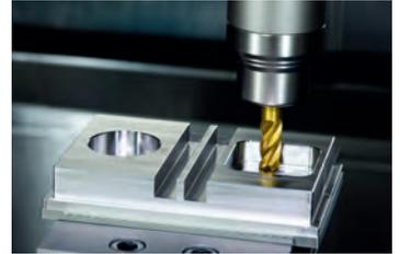
Die neuen TiNox-Fräser wurden speziell für die Anwendung in rostfreien Stählen sowie die Nass- und Trockenbearbeitung entwickelt. Die ergänzten Typen **221500** bis **221515** erreichen bis zu **84%** mehr Spanvolumen als herkömmliche Werkzeuge. Diese sind sowohl zum HPC-Schuppen, Taschenfräsen als auch zum Schlichten optimal einsetzbar.
