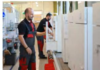
Nach der vollautomatischen Teilefertigung werden Fronten, Schubladen und Ausstattung manuell montiert.
