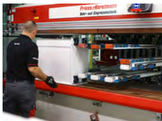
Zoom sur le montage : cette presse à meubles assemble un placard toutes les 30 secondes.
