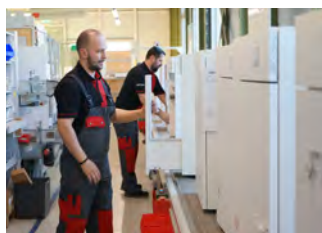
Après fabrication entièrement automatique des pièces, les façades, tiroirs et équipements sont montés manuellement.
