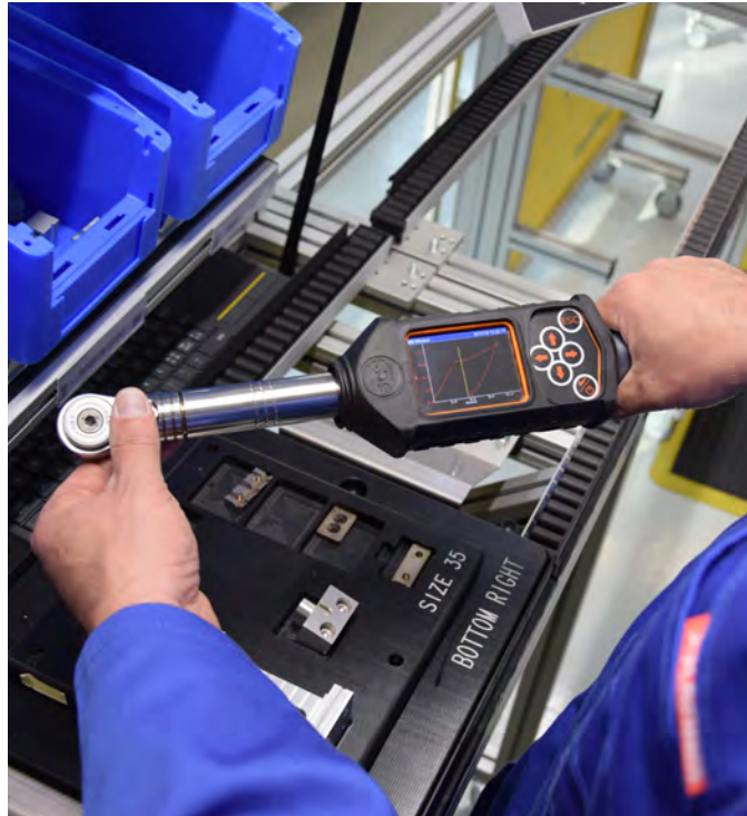
Prozessfähigkeits-Untersuchung an der Montagelinie.
