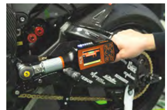
Rechtlich und wirtschaftlich sinnvoll: Prozesssicher verschrauben und dokumentierbar prüfen.
