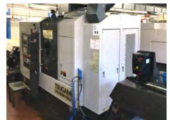
Auf diesem Tsugami-System werden auf fünf simultanen Achsen äusserst komplexe Teile gefertigt.
