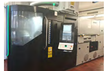
Fünfmal so schnell wie eine Einzelspindel: Diese Mehrspindelmaschine führt sechs Prozesse simultan durch.
