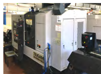
Des pièces d'une grande complexité sont fabriquées sur les cinq axes simultanés de ce centre de tournage Tsugami.
