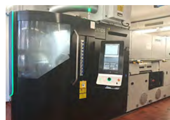
Cinq fois plus rapide qu'une broche simple : cette machine à broches multiples exécute simultanément six processus.
