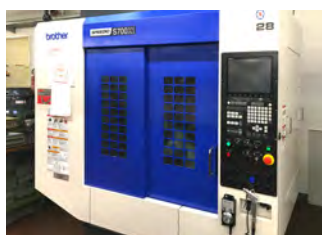
Centre d'usinage à cinq axes : les clients bénéficient d'une gamme complète de processus de fraissage.
