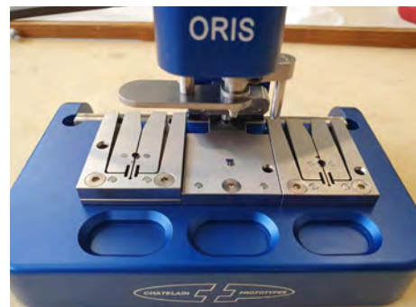
Für die zuverlässige Feinregulierung in der Montage: Werkzeug für ein Rückersystem.
