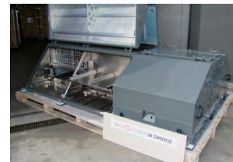
Aluminium-Stromrichtergehäuse für ein Lokomotivendach: Beinhaltet die Antriebs- und Regelelektronik.
