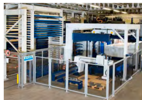
Effizienter Materialfluss: Direkt am Hochregallager angebundene Laserschneidanlage.
