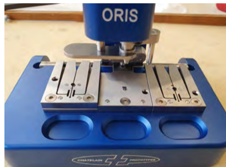
Pour un réglage précis et fiable lors du montage : un outil pour un système de raquette.
