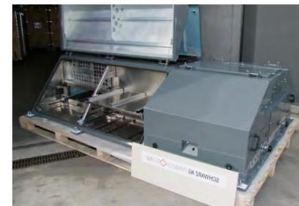
Boîtier de convertisseur en aluminium pour un toit de locomotive : contient l'électronique d'entraînement et de réglage.
