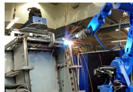
Haute technologie de soudage : un robot veille à une qualité élevée correspondant à la norme ferroviaire.
