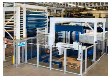
Flux de matériaux efficace : dispositif de découpe au laser directement lié à l'entrepôt à rayonnages hauts.
