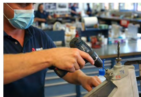
Equipements Brütsch/Rüegger Tools : perçage sur l'arceau de sécurité en aluminium imprimé 3D.
