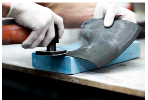
La finition de surface des composants imprimés en 3D requiert de la minutie.
