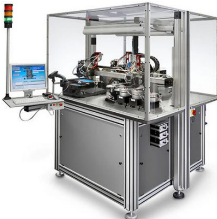
Système de montage automatisé pour faciliter le montage des montres et des horloges.
